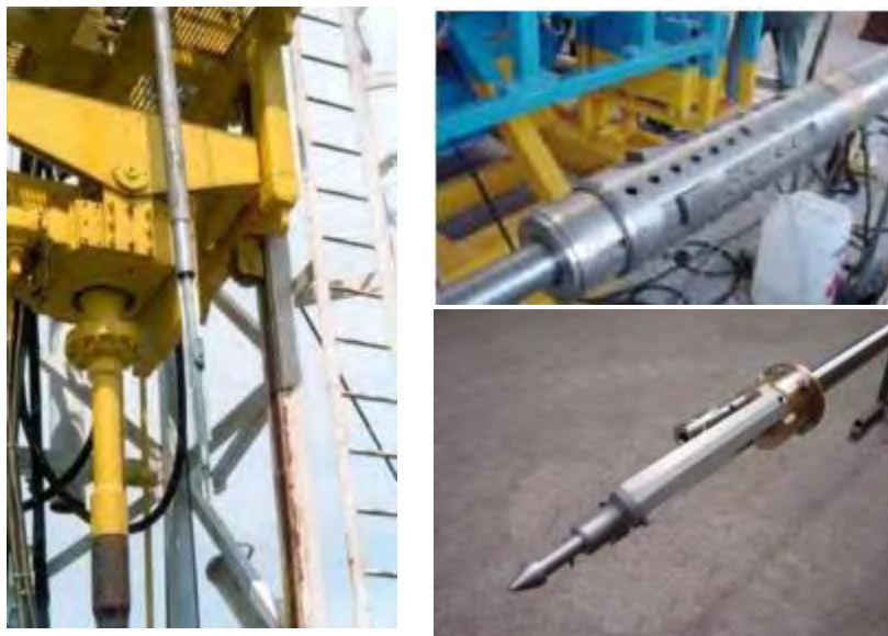
Рисунок 2.2-1. Комплекс внутрискважинного зондирования Wison-APB
