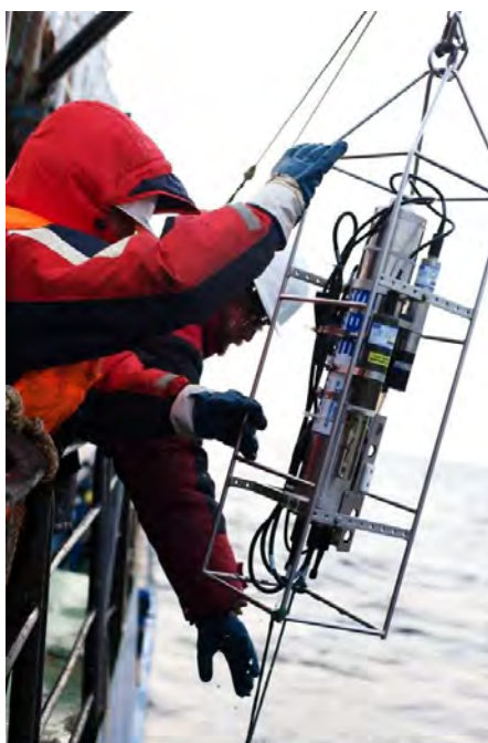
Рисунок 5.6-1. Зонд SBE 19plus V2
