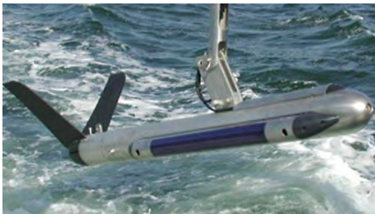
Рисунок 5.4-1. Внешний вид гидролокатора Klein 3000
