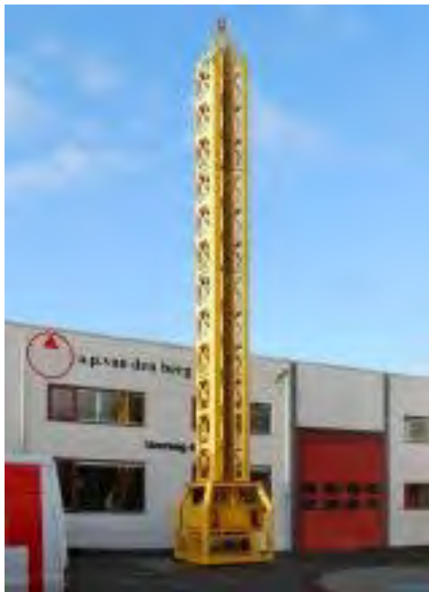
Рисунок 2.2-2. Установка статического зондирования Deep Water Roson 75/100kN
