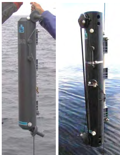
Рисунок 5.7-3. Батометры типа Нискина (слева) и типа Go Flo (справа)
